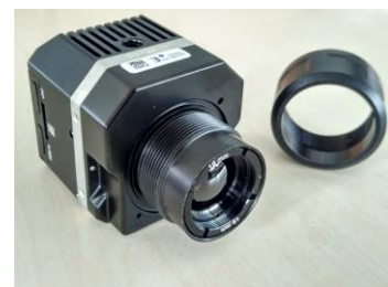
将镜头外侧的保护圈拧下
