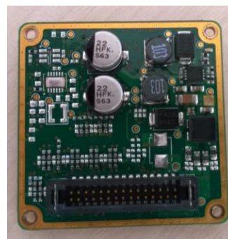
(普通装在 Tau2 机芯后面的)Photon 转接卡
