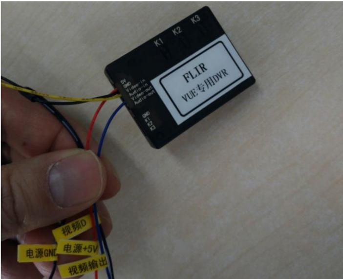
我们发货时，已经将 **DVR** 连接完毕，留有 **4** 根接线（已贴标签）需要使用者自己连接！
