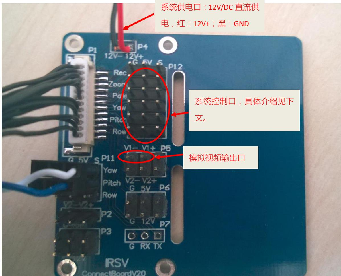
系统控制口：控制红外热成像系统各个功能的一系列 pwm 通道
